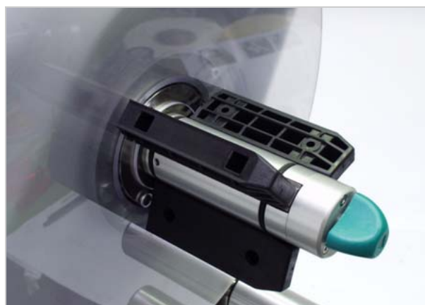
[45] Posición del adaptador de núcleos para un diámetro de núcleo de 101,6 mm.
