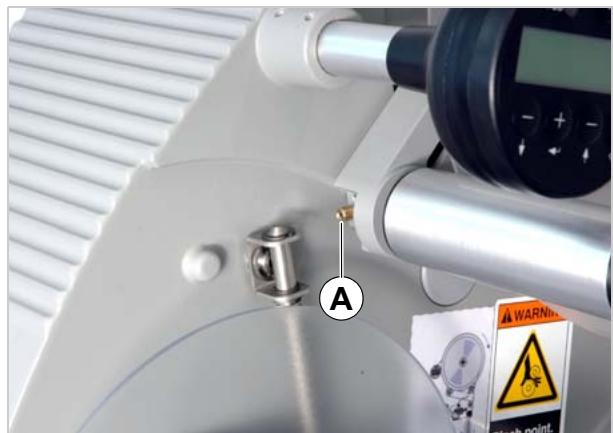
[48]] Tornillo de ajuste (A) en el brazo bailante del desenrollador.
