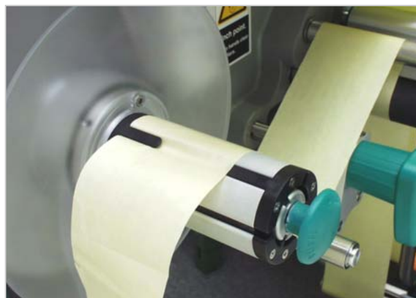
[43] Fijar el papel de soporte en el enrollador.
