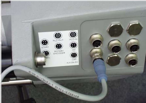
[8] Conexiones de los sensores del ALS 20x (DER)
