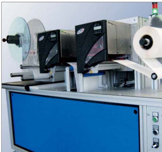
[6] Aplicación con dos módulos PEM para la impresión bicolor. Entre ambos PEMs se encuentra un bucle de buffer. En el lado izquierdo se enrolla el material impreso.
