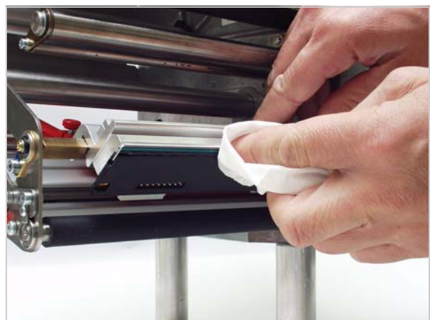
[65] Limpiar el cabezal de impresión con alcohol.
