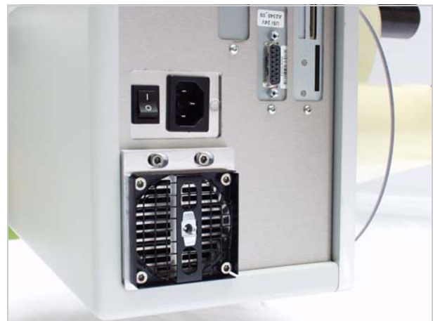
[79] Caja de filtro retirada.
