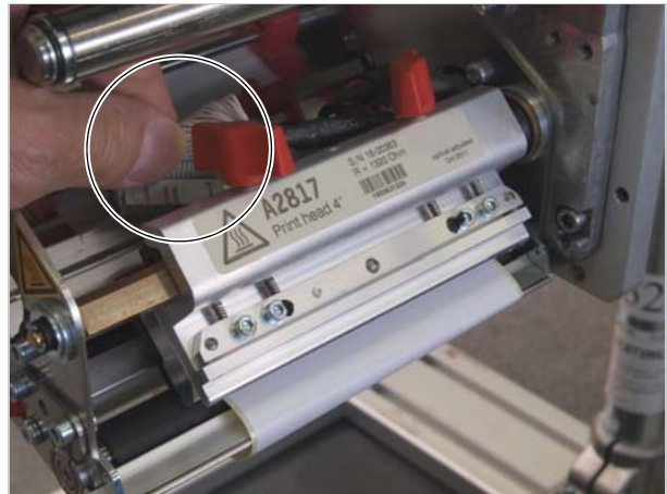
[66] Desconectar el cable de conexión.
