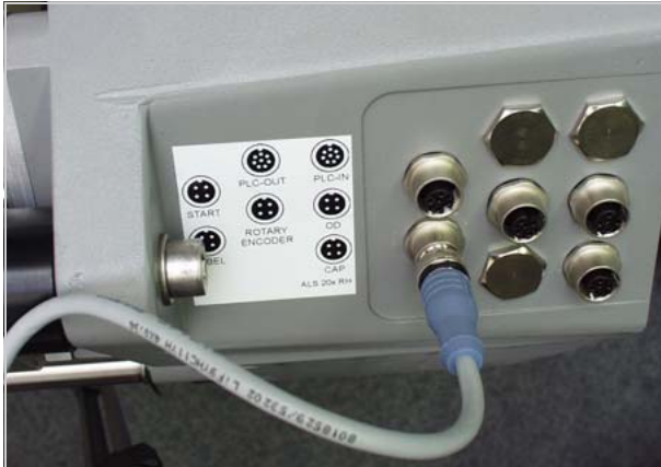
[10] Sensor connections on the ALS 20x (RH)
