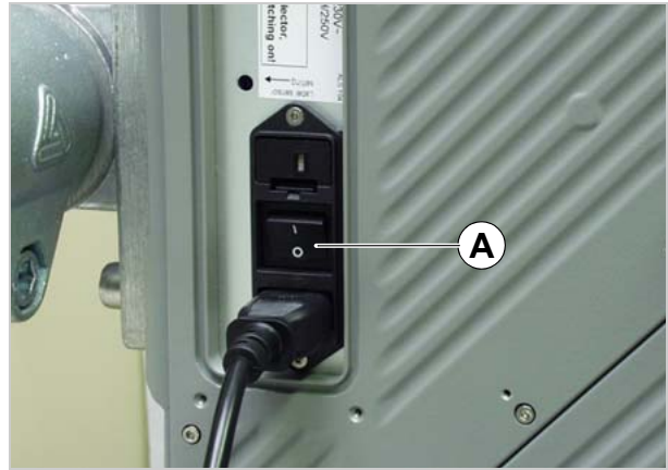
[42] Interruptor principal (A) del ALS 104.
