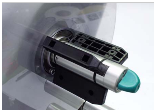
[38] Posición del adaptador de núcleos para un diámetro de núcleo de 101,6 mm.
