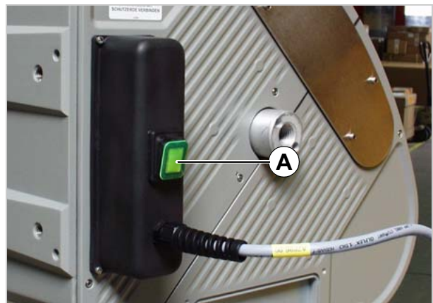
[43] Interruptor principal (A) del ALS 104 con protección contra salpicaduras.
