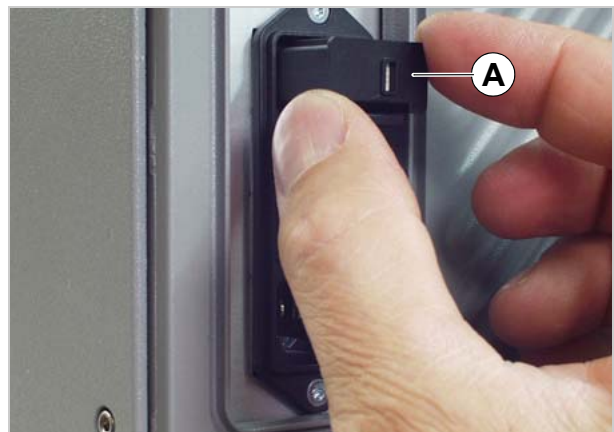
[48] Extraer la caja de fusibles (A).
